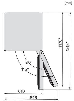
KFN4375DD, KFN4395DD, KFN4393FD, KFN4393D,
