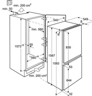
1) Freies Einbaumass auf Scharnier min. 545 mm
