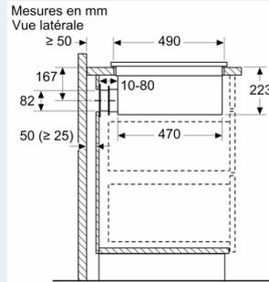
En cas d'installation directement contre des murs extérieurs qui ne sont pas isolés ( $\mu \geq 0,5 \text{ W/m}^2 \text{ } ^\circ\text{C}$ ), nous recommandons d'utiliser des configurations de recyclage partiellement ou totalement gainées.
