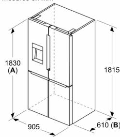
**A:** La façade est réglable de 1830–1847 mm, avec les pieds de nivellement avant à sortie totale
