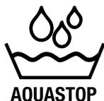
**Aqua Stop total** – La plus grande sécurité. Si le tuyau d'arrivée est endommagé, le système AquaStop est activé et l'arrivée d'eau est interrompue. Si de l'eau s'écoule dans le bac de fond, le flotteur monte. Un système d'arrêt interrompt l'arrivée d'eau et la pompe se met en marche.
